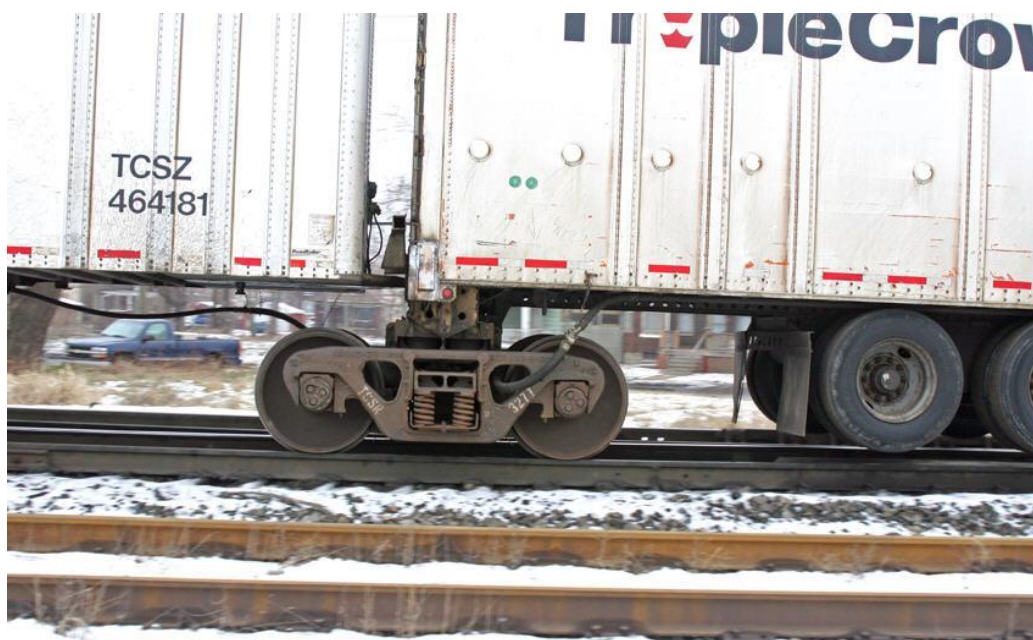
Рис. 1.34. Железнодорожный ходовой узел роудрейлера.
