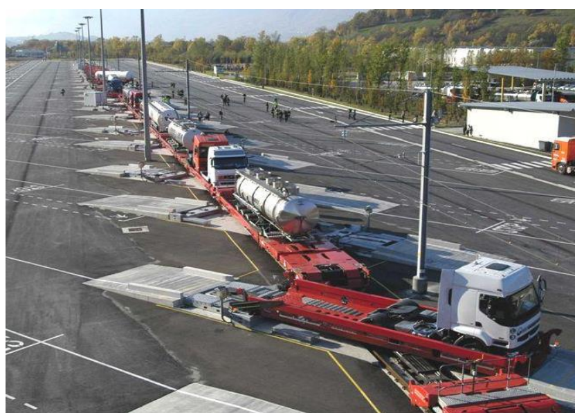
Рис. 1.32. Погрузка на специальные железнодорожные платформы на контрейлерном терминале
