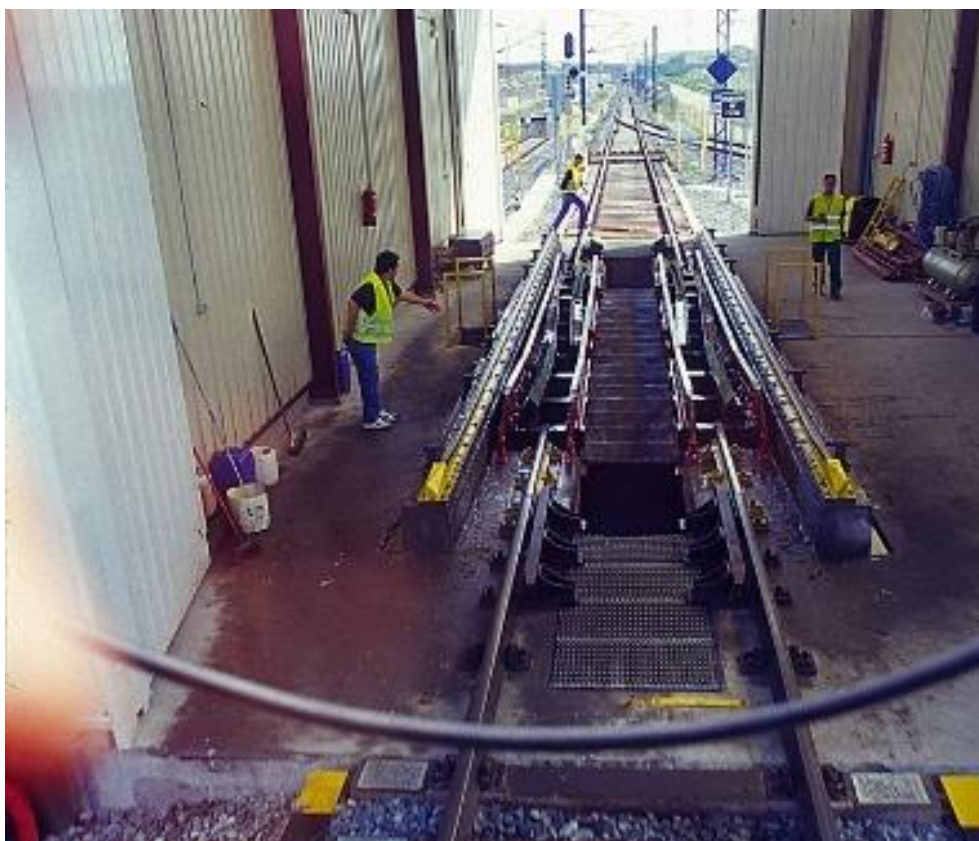
Рис. 1.46. Установка сдвига колесных пар. Вид со стороны колеи 1435 мм
