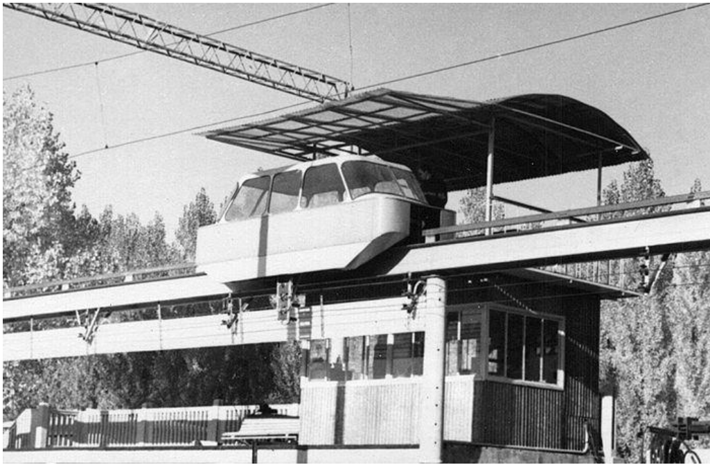
Рис. 1.16. Первая в мире рельсовая дорога с линейным тяговым двигателем, конец 60-х годов прошлого века, Киев, СССР.
