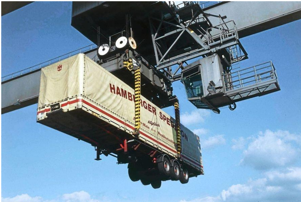
Рис. 1.36. Вертикальная погрузка контейнера на судно
