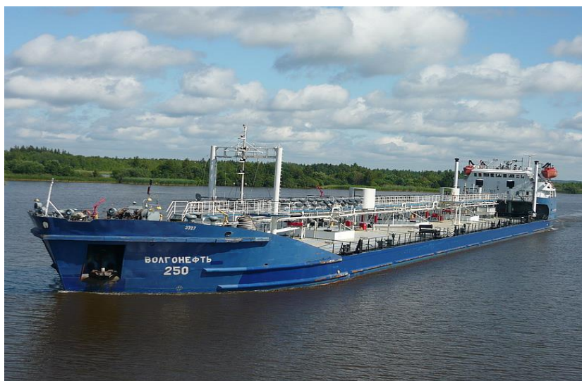
Рис. 1.43. Нефтеналивное судно типа «река-море»
