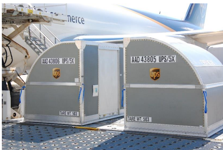
Рис. 1.23. Авиационный контейнер типоразмер IATA ULD тип 7
